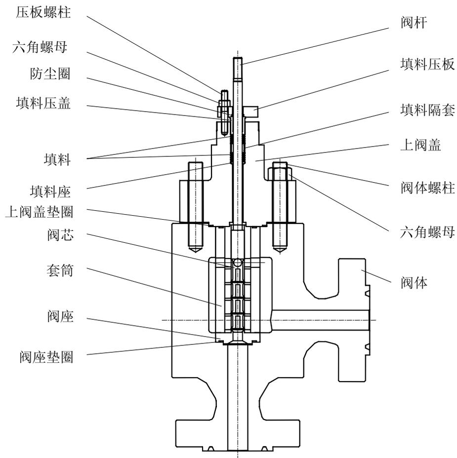
图 5-1(压力不平衡型)
